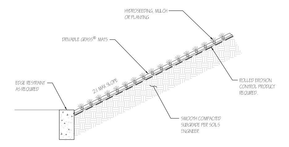
TYPICAL PROFESSIONAL DRIVABLE GRASS® PLANTED SLOPE EROSION CONTROL DETAIL SCALE; |'' = |'
